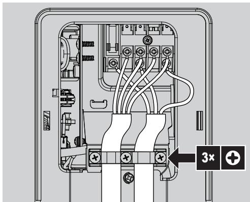
**5** Skrutky svorkovnice dôkladne dotiahnite. Odporúčame použiť skrutkovač Phillips.
