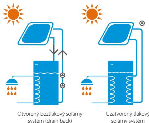
Solárna jednotka je vybavená pokročilým ľahkým plastovým zásobníkom s výnimočnými tepleno-izolačnými vlastnosťami. Pri prietokovom ohrevu vody odpadá problém s tvorbou baktérií. Takto sa eliminuje potreba tepelného dezinfekčného cyklu.
