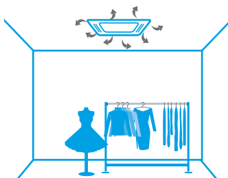
Rozvod vzduchu so špinavým filtrom
